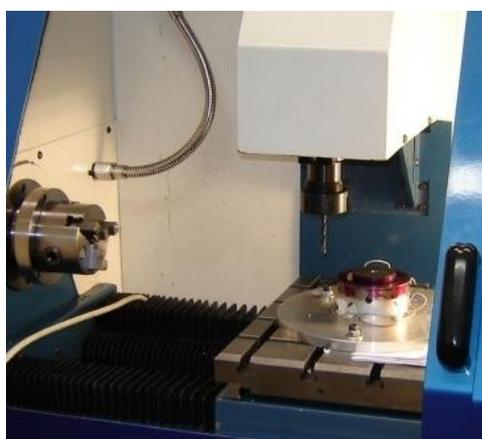
Figura 11. Dispositivo para medição de esforços de corte durante a furação montado no mini torno-fresadora CNC
