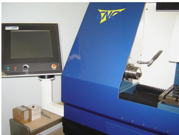
Figura 6. Mini torno-fresadora CNC MMC-LM. Cabeçote do torno e painel de controle
