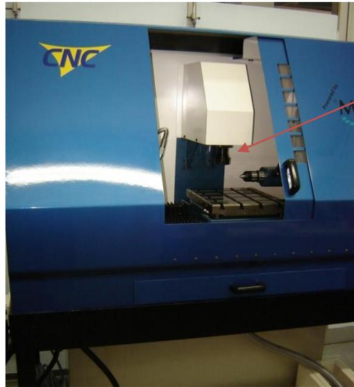
Figura 5. Mini torno-fresadora CNC MMC-LM. Cabeçote da fresadora (indicado pela seta) e mesa
