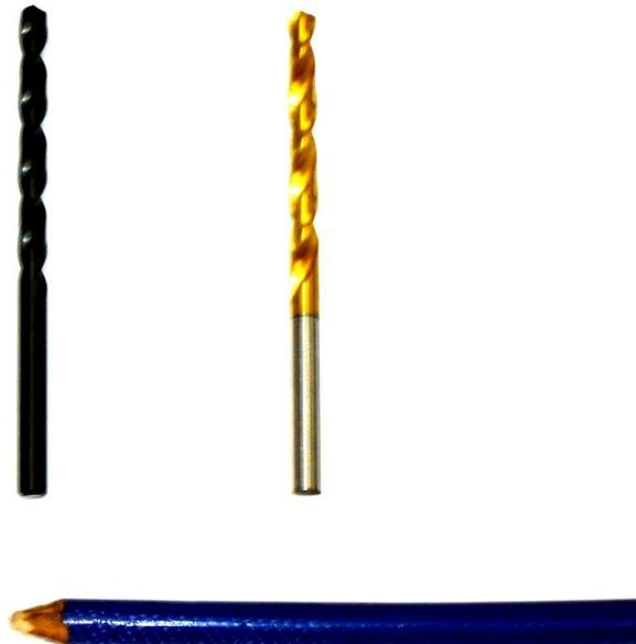
Figura 4. Brocas helicoidais sem (a esquerda) e com recobrimento de TiN (a direita, amarela).
