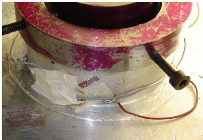
Figura 9. Detalhe de extensômetro a  $45^\circ$  no dispositivo para avaliação do momento torçor
